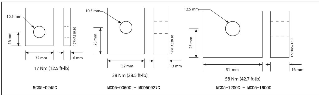
在 MCD5-0360C - MCD5-1600C 型号上，可以根据需要为顶部或底部输入和输出调整母线。有关如何调整母线的分步说明，请参考随附插页。
